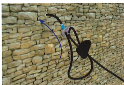
Fig.13 | DAFI : le dispositif d'ancrage façade par l'intérieur SOURCE : ORANGE
