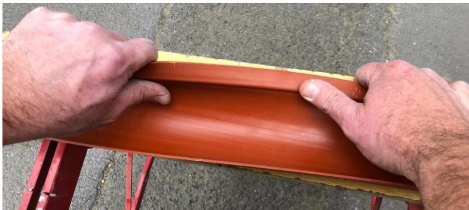
Posez-le ensuite sur une surface plane pour vérifier que CABLE COVER est bien droit / rectiligne et répétez la manipulation si nécessaire.
